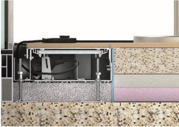
Figura 3. As calhas OKB são instaladas diretamente no betão inacabado.
