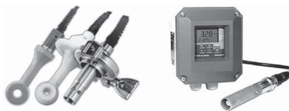
Figura 1 - Alguns modelos de células de condutividade e transmissor com indicação local.
