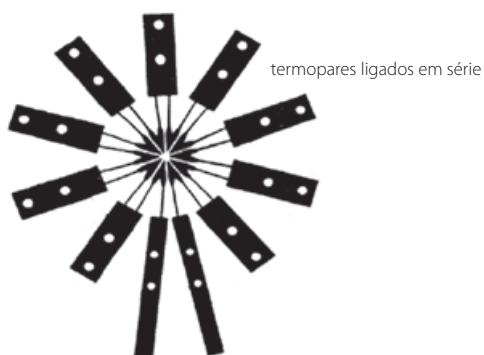
Figura 5. Esquema de uma termopilha em associação série de termopares.
