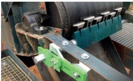
No caso de obstáculos ou ligadores mecânicos no tapete, os raspadores convencionais não fornecem resultados de limpeza suficientes e danificam o tapete permanentemente, possivelmente até rasgando-o. Os raspadores STARCLEAN®, marca representada em Portugal pela JUNCOR, para tapetes transportadores alcançam resultados de limpeza ideais graças à sua função TWIST-SWING® exclusiva - ao mesmo tempo que protegem o tapete.
