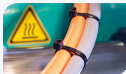
Estas abraçadeiras com dentado interno são feitas de poliamida 6.6. estabilizada ao calor (PA66HS). Podem ser aplicadas em ambientes com temperaturas constantes de até +105 °C. As abraçadeiras da série T
