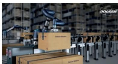
A Doosan Robotics disponibiliza na sua gama a séries H, ideal para tarefas que exijam mais capacidade de carga e alcance. O modelo H2515 apresenta uma capacidade de carga de 25 kg, com um alcance de 1500 mm, enquanto o H2017, 20 kg e 1700 mm. De realçar a repetibilidade de  $\pm 0,1$  mm. Ideais para aplicações colaborativas mais exigentes a nível de carga e alcance.
