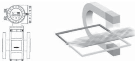
Figura 9 - Caudalímetro electromagnético com transmissor incorporado e representação da teoria de Faraday
