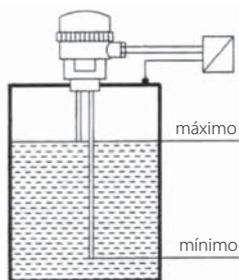
Figura 1. Deteção dos valores limites.
